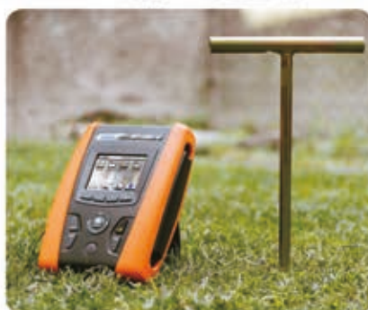
使用伏安法测量接地电阻
