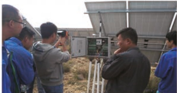
在青海共和某光伏电站用红外热像仪检测汇流箱异常发热点
