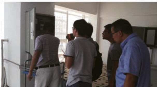
用红外热像仪测试汇流箱,看是否存在异常发热点
