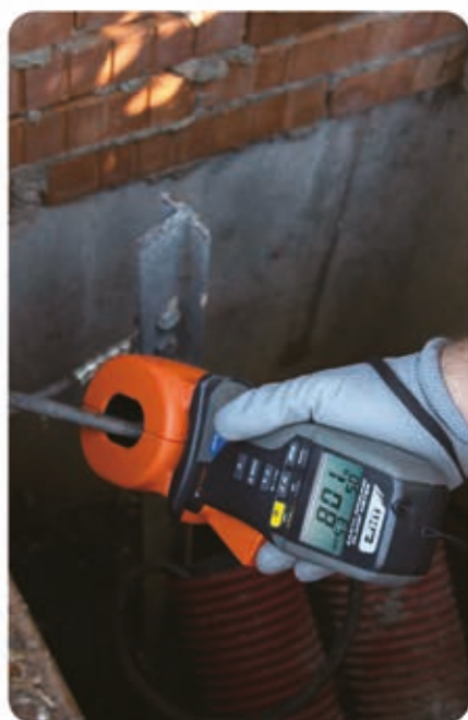
使用钳形表T2100测量接地电阻
