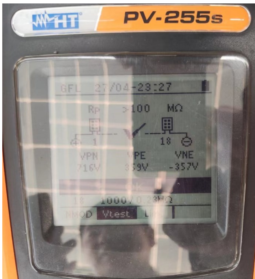
绝缘缺陷定位测试后显示界面
